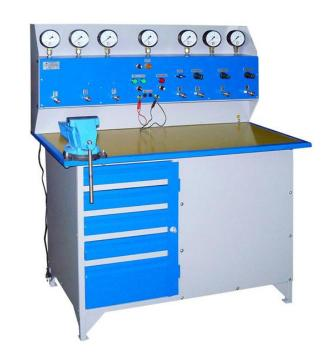
Каждый контур давления состоит из: крана-регулятора давления, связанного с общим компенсационным ресивером (объем=20л), контрольного манометра, гибких шлангов с быстродействующими разъемами присоединяемыми к пневмоприборам.
