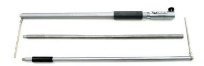
Прибор используется для контроля схождения передних колес легковых и грузовых автомобилей
